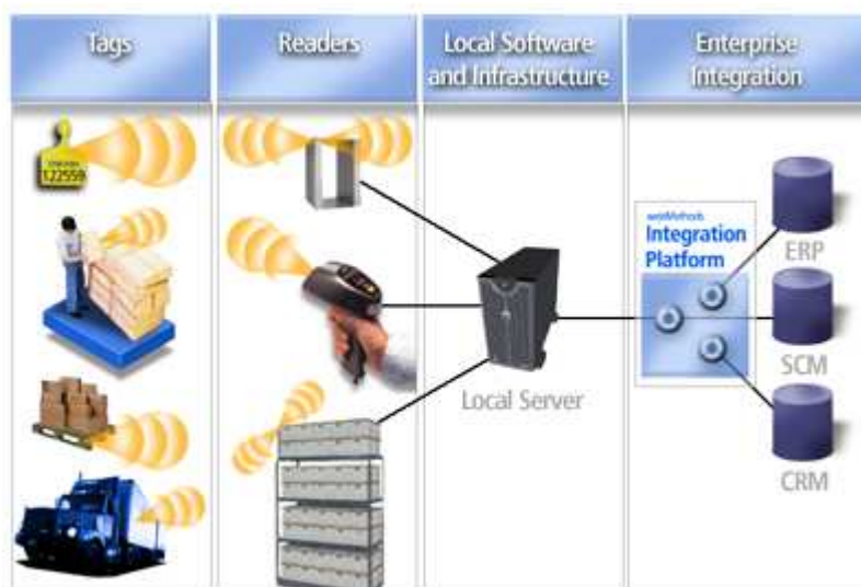
Fig. 8. A sample for working diagram of RFID Rys. 8. Przykład diagramu opartego na RFID
