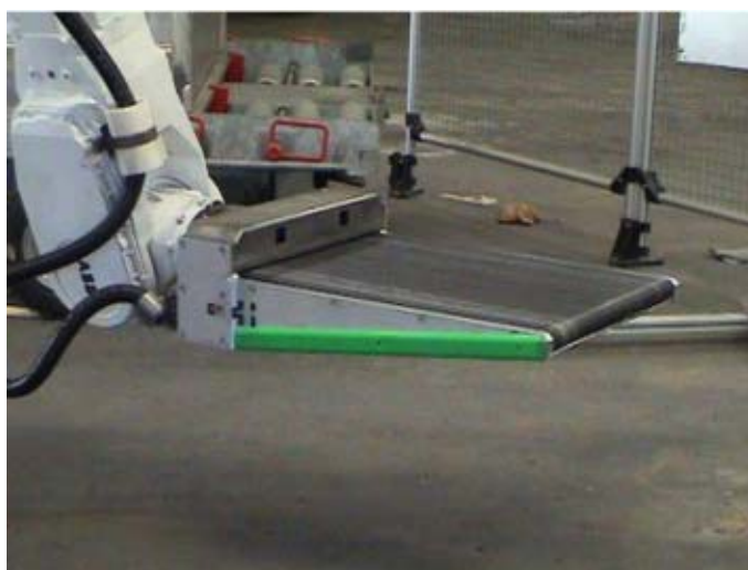
Fig. 6. ONERO system solution “baggage-handling” in Zurich Rys. 6. System ONERO stosowany w obsłudze bagażu w Zurychu
