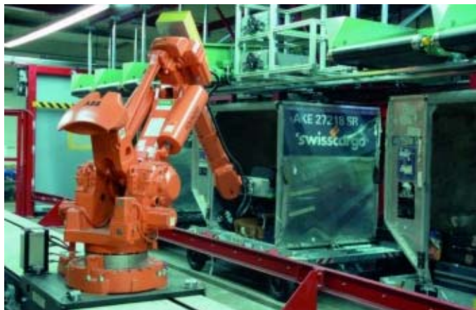
Fig. 6. ONERO system solution “baggage-handling” in Zurich Rys. 6. System ONERO stosowany w obsłudze bagażu w Zurychu
