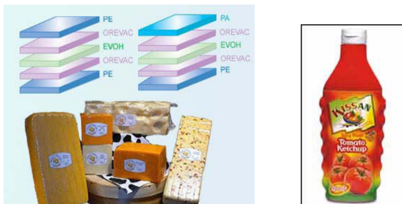
Fig. 3. Ethylene-vinyl alcohol copolymer (EVOH) used in shrinkable films and plastic containers Rys. 3. Zastosowanie kopolimeru EVOH w kurczliwych foliach i opakowaniach plastikowych
