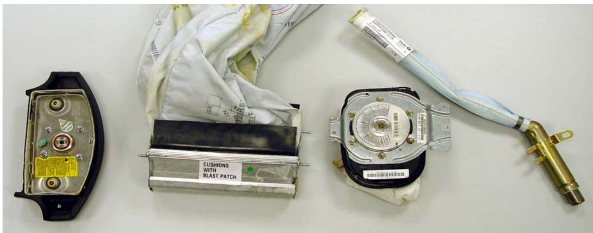
Fig. 3. (left to right) driver airbag, co-driver airbag, sidebag, windowbag Rys. 3. (do lewej do prawej) poduszka powietrzna kierowcy, pasażera, boczna i okienna
